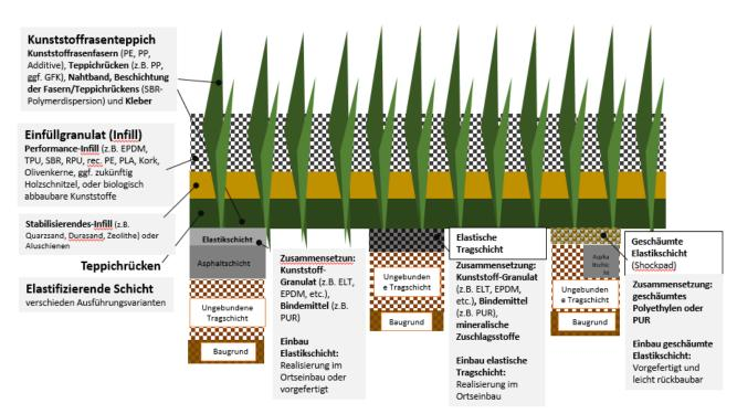
**Abkürzungen:** PE - Polyethylen / PP - Polypropylen / ELT - End-<u>of-life tire</u> / EPDM - Ethylen-Propylen-Dien-(Monomer)-Kautschuk / GFK - glasfaserverstärkter Kunststoff / SBR - Styrol-Butadien-Kautschuk / RPU - Recycling-Polyurethan / PLA - Polylactid / PUR - Polyurethan / TPU - thermoplastisches Polyurethan
